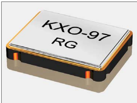
Bild 1: Einfacher Oszillator in SMD-Bauform in der Größe 7 x 5 mm. Solche Oszillatoren sind erhältlich für die Frequenzen von 1,0 MHz bis 160 MHz und für Versorgungsspannungen von 1,8 V / 2,5 V / 3,0 V / 3,3 V und 5 V. (GEYER ELECTRONIC)
